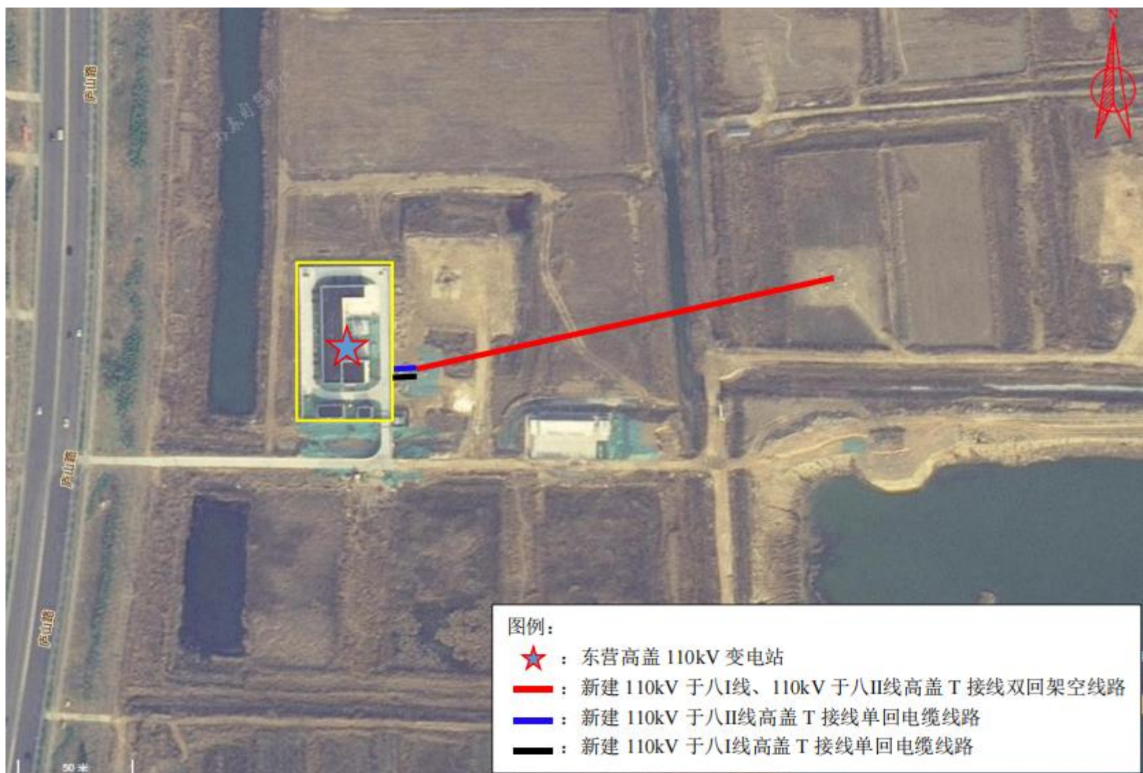
图4-4 本工程线路实际建设路径图
